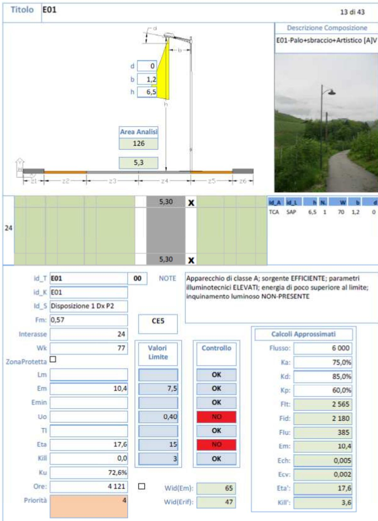
Fig. 30 - Scheda delle caratteristiche relative alla composizione analizzata prodotta dal software Rilievo-ILL
