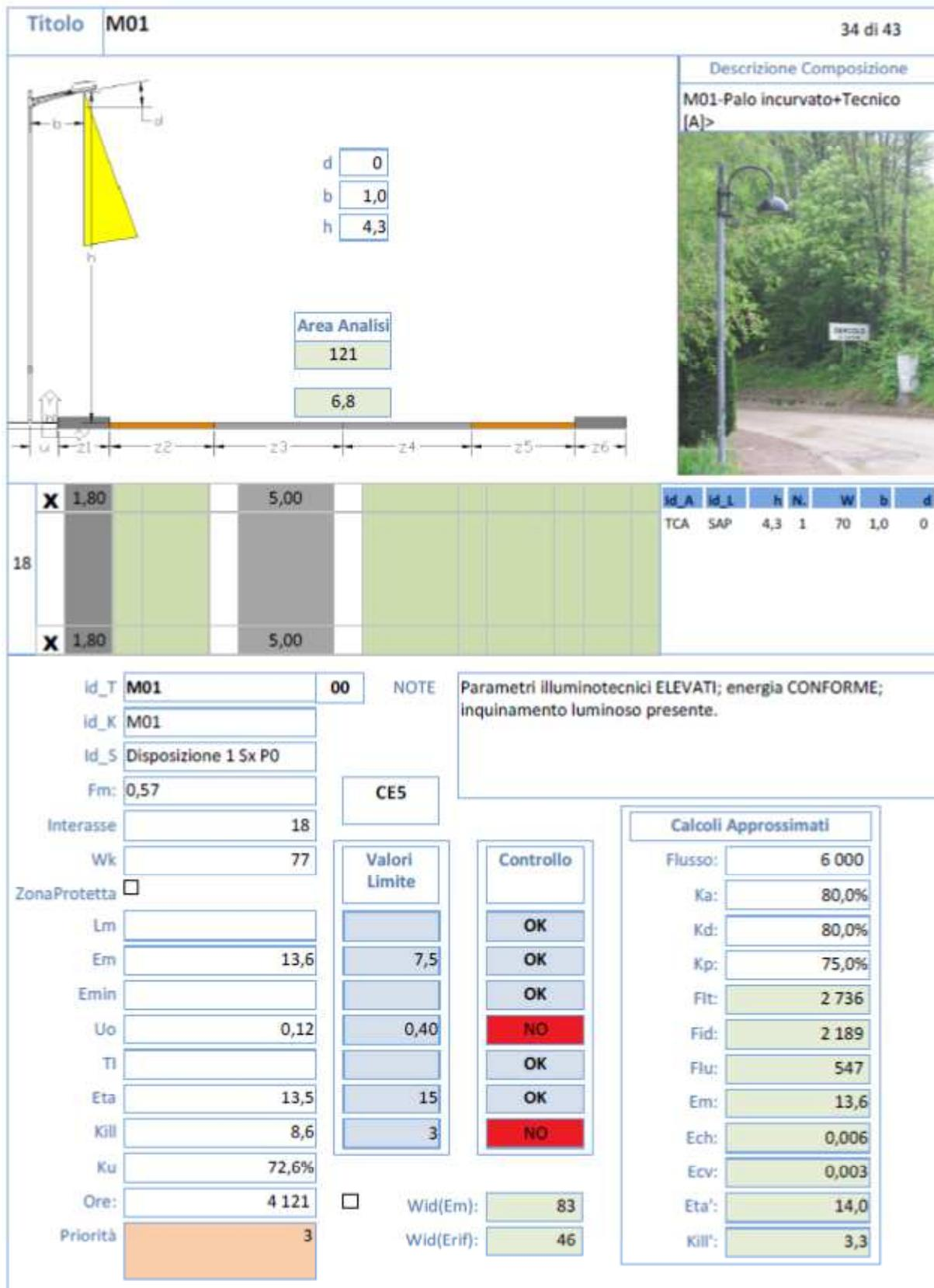
Fig. 28 - Scheda delle caratteristiche relative alla composizione analizzata prodotta dal software Rilievo-ILL
