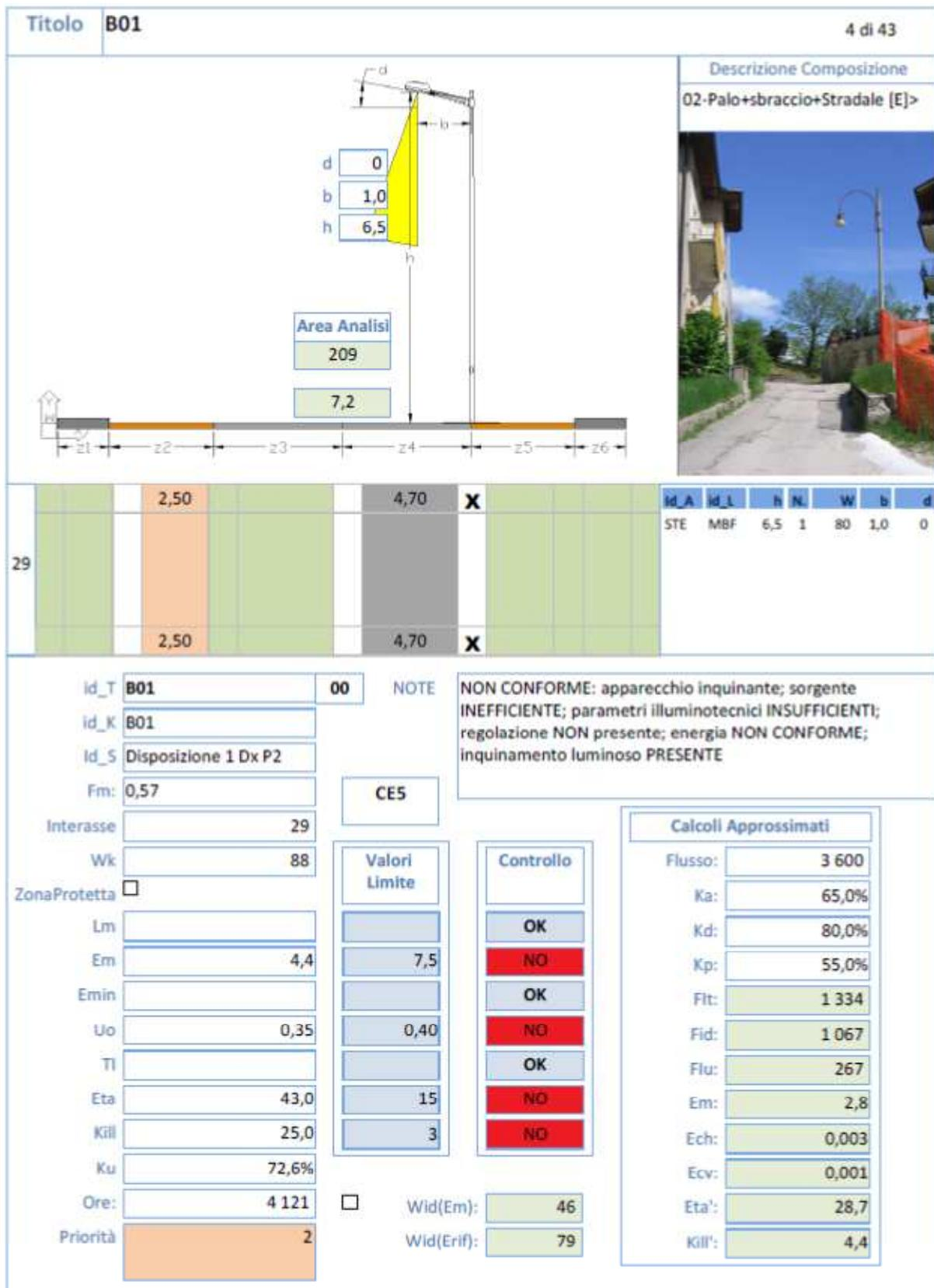
Fig. 24 - Scheda delle caratteristiche relative alla composizione analizzata prodotta dal software Rilievo-ILL
